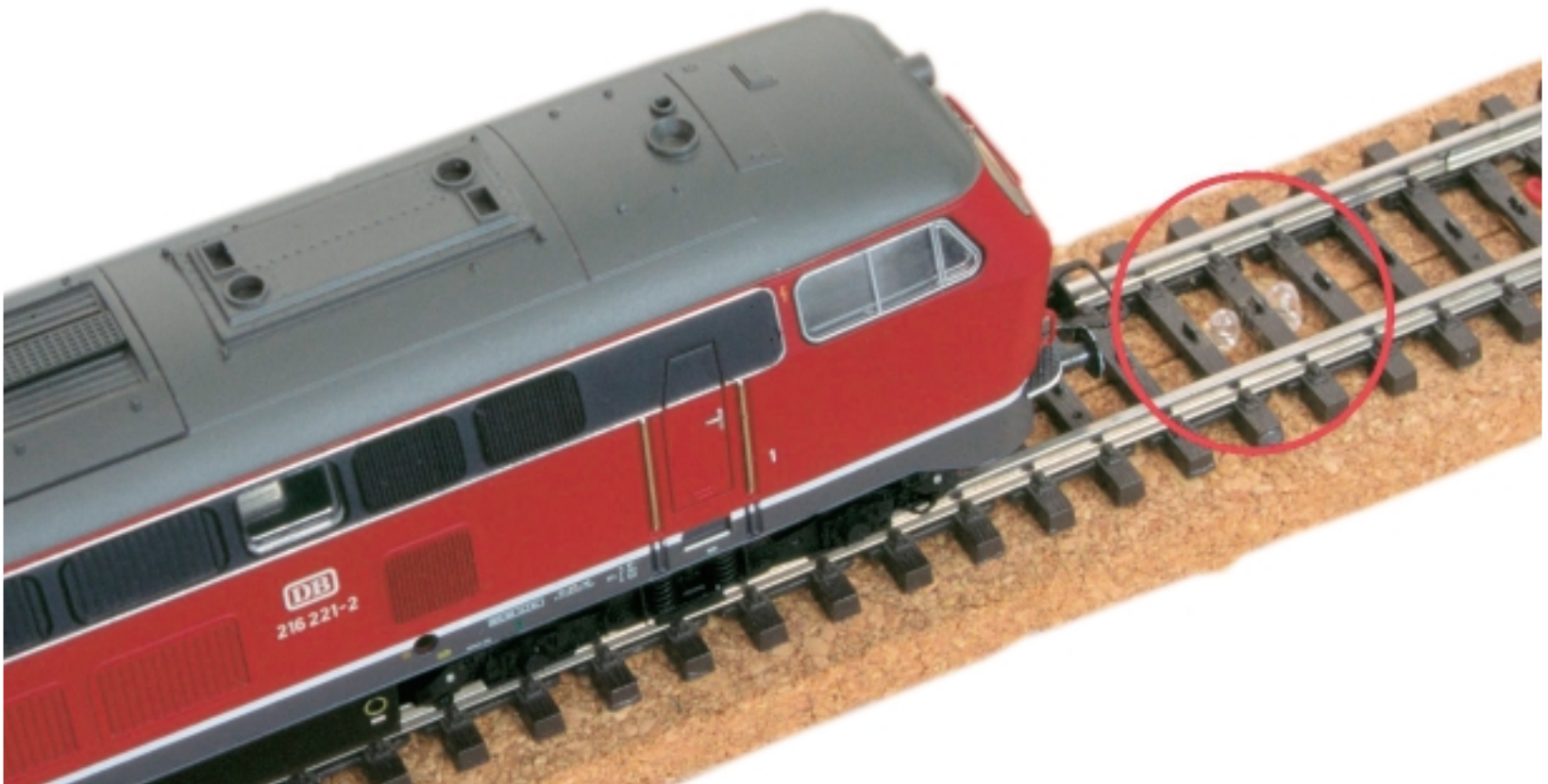
Kaum zu erkennen: Fotodetektoren (roter Kreis) nach dem Einbau im Gleis.
