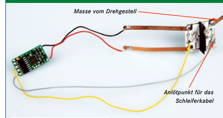
Das Dach des Wagens wird abgenommen und die Platine mit der Beleuchtung vorsichtig herausgezogen.
