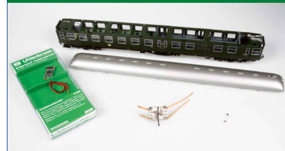
Das Dach des Wagens wird abgenommen und die Platine mit der Beleuchtung vorsichtig herausgezogen.
