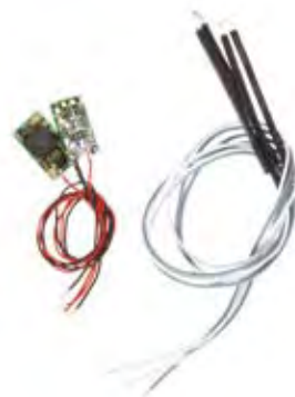
Basisset 68000: LISSY-Empfänger und zwei LISSY-Sender nebst Sensoren für den Uhlenbrock-Empfänger.
