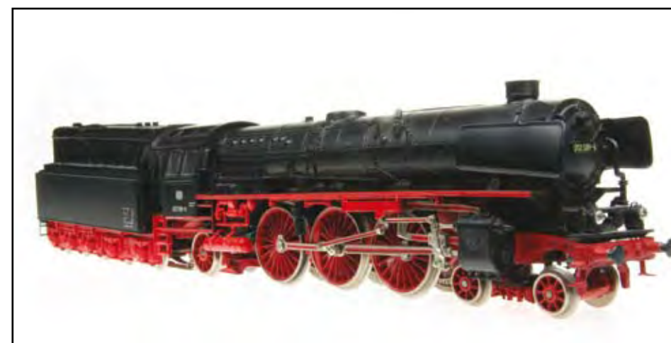
Beispiel 1: Digitalisierung einer Lok mit Allstrommotor. Wir verwenden beispielhaft die analoge Dampflokomotive der Baureihe 012 Öl mit Allstrommotor und Umschaltrelais mit Vorschalt elektronik von Märklin (Artikelnummer 3310). Der Umbau erfolgt mit einem Uhlenbrock-Multiprotokoll-Decoder 76200, so dass keine aufwändige Umrüstung des Motors, also der Ersatz der Feldspule durch einen Permanentmagneten, erfolgen muss. Das nachträgliche Anstecken eines Soundmoduls ist möglich.
