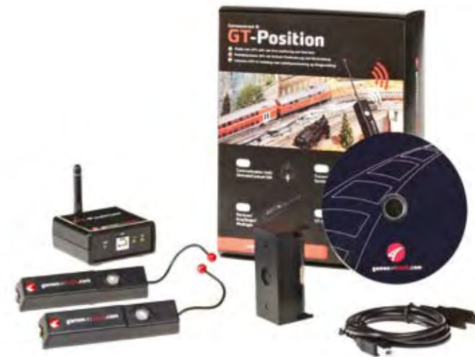
GT-Position (UVP: 399 Euro): Funktioniert wie ein Pkw-Abstandswarner via Ultraschall.
