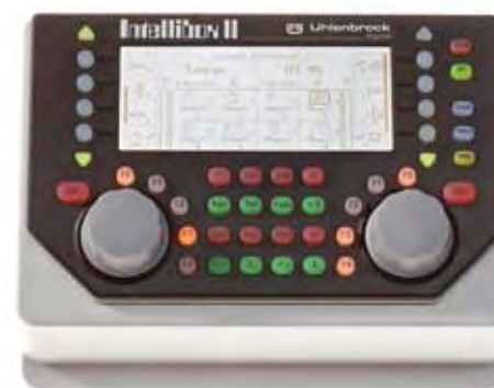
Uhlenbrocks Intellibox II ist vielsprachig und eignet sich zur Steuerung mit DCC, Motorola und Selectrix.
