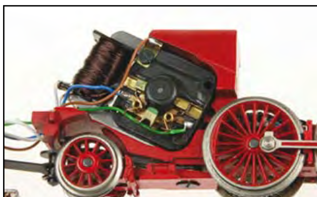
6. Die Kabel für Masse (braun) und Motoranschlüsse (blau und grün) sind in der Länge anzupassen und zu verlöten.
