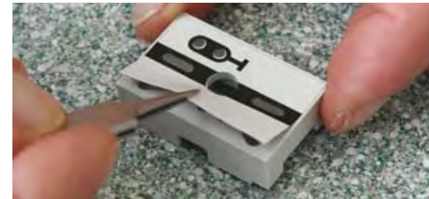
Aufkleben der Folien auf die Track-Control-Segmente.
