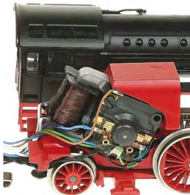
Leicht zu erkennen: Allstrommotor mit Kupferspule.
