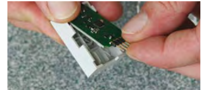
Nach der Streuscheibe wird die Platine eingelegt.
