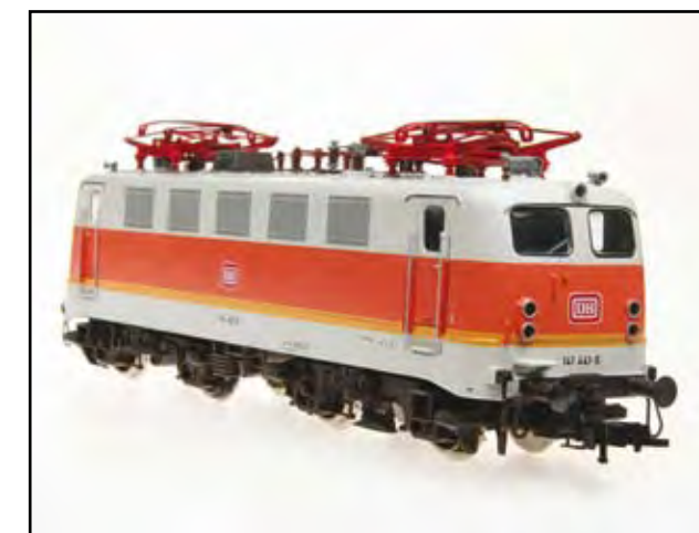
Beispiel 2: Nachrüstung einer Schnittstelle und von Sound. Beispielhaft verwenden wir die analoge Elektrolok BR 141 von Fleischmann (Artikelnummer 4329). Eingebaut werden die Uhlenbrock-PluX-Universalplatine 71680 und der RailCom-Sounddecoder 36364. Die PluX-Schnittstelle ermöglicht einen schnellen Austausch des Decoders.
