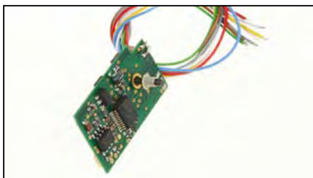
5. Beim Märklin-Modell können wir den Decoder an der vorhandenen Halterung für das Umschaltrelais befestigen. Dazu verwenden wir die vorhandenen Schrauben. Beim Anschrauben ist sicherzustellen, dass die Decoderplatine nirgendwo einen Massekontakt erhält. Dazu kann eine Isolierung oder ein Kunststoffring herangezogen werden. In unserem Fall konnte die vorhandene Kunststoffhülse weitergenutzt werden.
