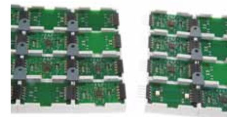
So sieht ein fertig »verdrahtetes« Uhlenbrock-Stellpult von unten aus.
