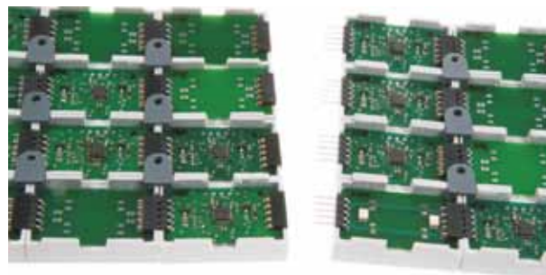
So sieht ein fertig »verdrahtetes« Uhlenbrock-Stellpult von unten aus.
