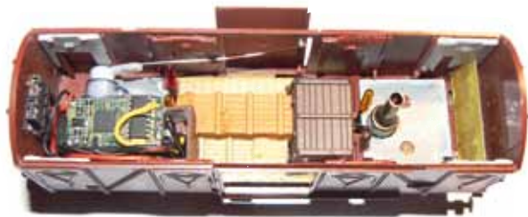
HO-Güterwagen mit Digital-Servo, das eine Wagentür öffnet, und Digitaldecoder für Licht und Rauch
