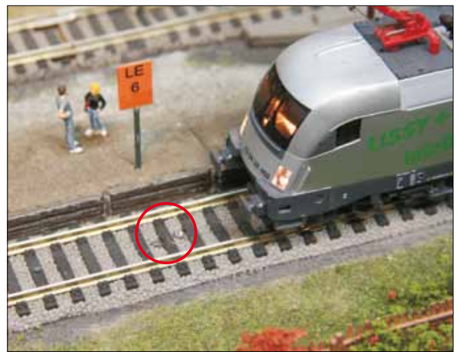
Kaum sichtbar: in das Gleis eingebaute LISSY-Empfängersensoren
