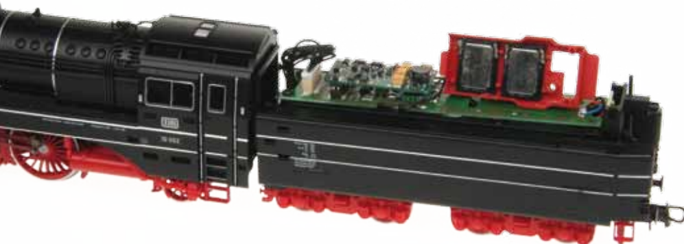
Sounddecoder 35 330 und 2 Lautsprecher 31 101 eingebaut in eine Roco BR 10
