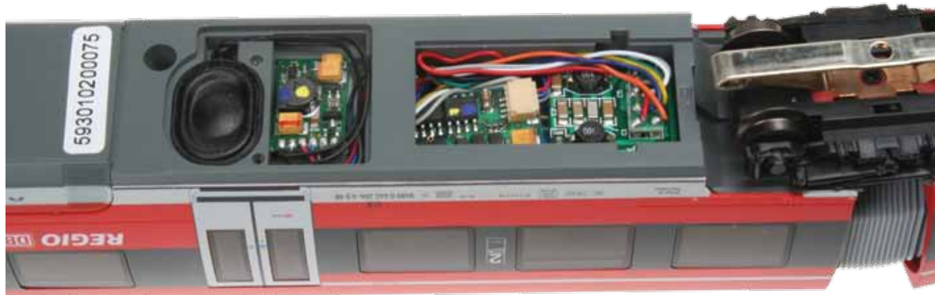
SUSI Schnittstelle in Aktion: Piko Talent 2 mit Decoder 76425, Soundmodul 32300 und Lautsprecher 31180
